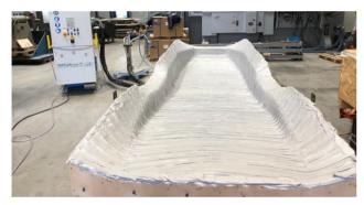
Das Laminierwerkzeug, in der Länge 6,30m, härtet bei Raumtemperatur aus und wird anschließend getempert.
