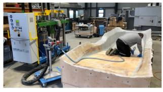
Hier wird die Epoxid-Paste auf die vorgefräste Unterkonstruktion eines Laminierwerkzeugs mit unserer Nodopox 200 Anlage aufgetragen.
