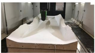
Schlichtbearbeitung und ansticheln der Fertigteilkontur.
